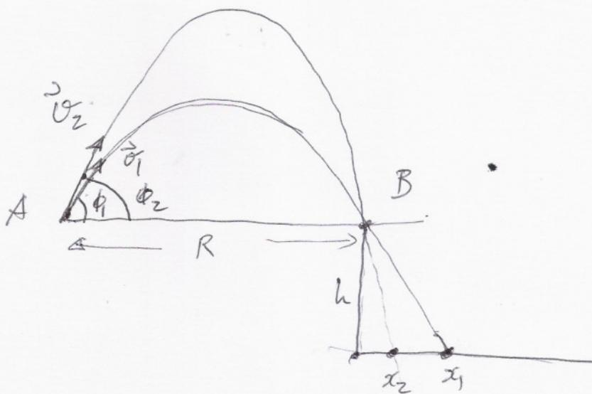
0,5 A figura representa duas trajetórias de lançamentos a  $v_1 < v_2$  e  $\phi_1 < \phi_2$  para atingir o mesmo alcance  $R$ .
